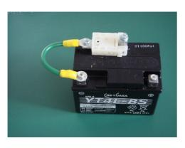
取り付けスペースがない時は、写真のように 延長コードを使用して、スペースのある所まで 廻してからコネクターを取り付けます。
